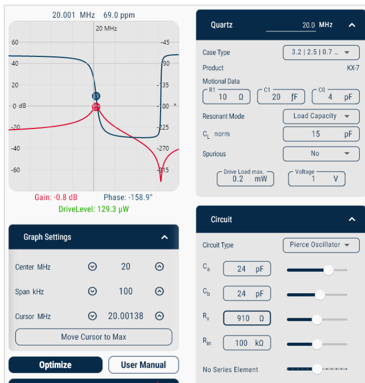
Bild 16 Pierce-Oszillator, symmetrischer Wahl C_a und C_b (24/24 pF)
