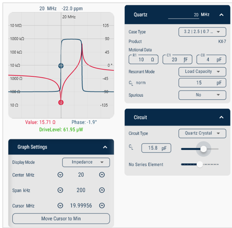
Bild 10 Schwingquarz mit Serien-(Last)-Kapazität
