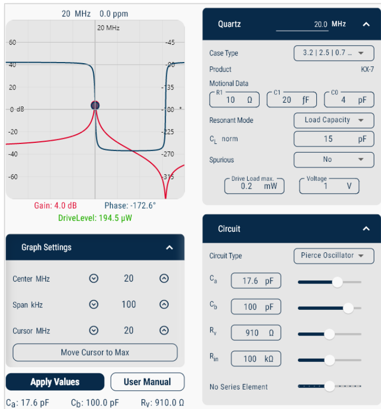
Bild 15 Pierce-Oszillator, symmetrische (22 pF / 22 pF / 300 Ω) und asymmetrische Wahl von C_a und C_b (18/110 pF)
