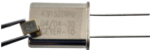
Bild 1: Ein moderner SMD-Quarz über einem Quarz der älteren Bauform „HC-49“ (3,2 x 2,5 mm bzw. 13 x 10 mm). Das Volumen für die Unterbringung der Quarzscheibe ist sehr viel kleiner. Das hat Folgen für die elektrischen Eigenschaften, die beachtet werden müssen. (GEYER Electronic)
