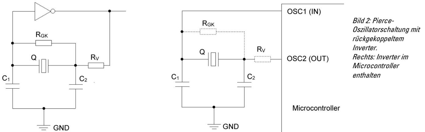
Bei Microcontrollern ist meist der Inverter für diese Pierce-Oszillatorschaltung bereits enthalten. Dies erlaubt zudem sehr einfach, statt eines Quarzes einen Oszillator an OSC1 anzuschließen und OSC2 offen zu lassen.
