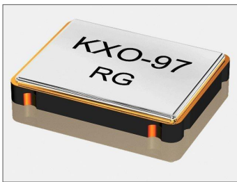
Bild 1: Einfacher Oszillator in SMD-Bauform in der Größe 7 x 5 mm. Solche Oszillatoren sind erhältlich für die Frequenzen von 1,0 MHz bis 160 MHz und für Versorgungsspannungen von 1,8 V / 2,5 V / 3,0 V / 3,3 V und 5 V (GEYER Electronic)
